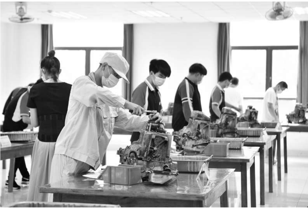
学生进行发动机缸体测量实训。
