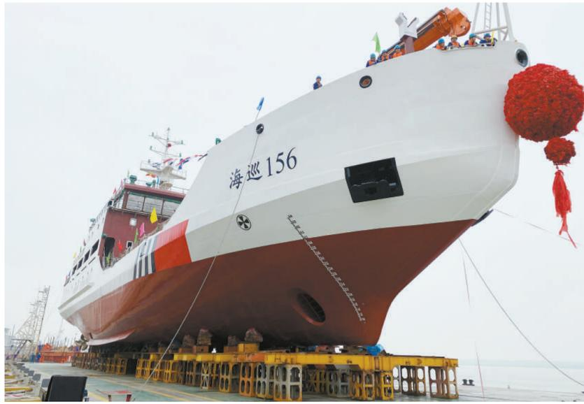
4月15日,我国首艘具备破冰能力的大型航标船“海巡156”轮在中国船舶重工集团双柳造船基地下水(如图),预计今年9月列编交通运输部北海航海保障中心,将主要用于北方冰冻港口、航道的助航设施布设、撤除、更换和维护作业。“海巡156”轮总长74.9米,型宽14.3米,型深6.2米,排水量约2400吨,采用全电力驱动、双回转舵桨推进系统,具有优秀的操控能力和航标作业能力。该轮也是国内首艘根据中国船级社智能机舱和智能能效要求建设的大型航标船,具备智能决策支持和维护功能。 特约记者 邢村村 文 李勇 图
